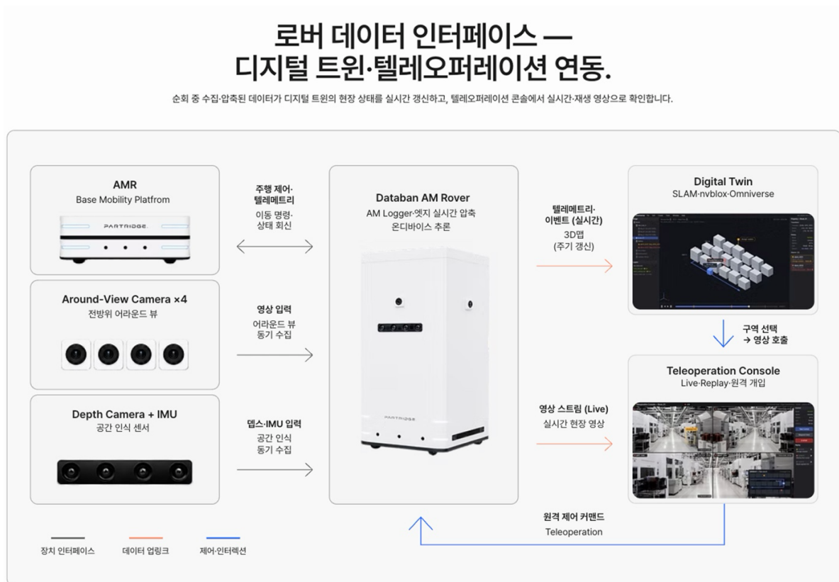
Figure 3-1. Rover 데이터 인터페이스 — 디지털 트윈·텔레오퍼레이션 연동
